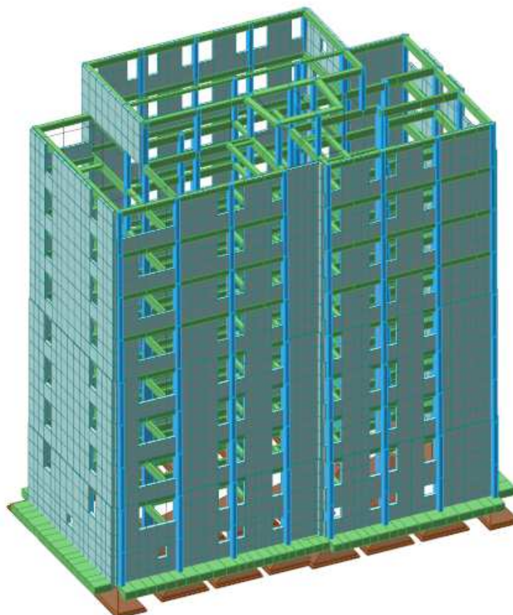
Figura 3: modello generale – edificio con cappotto sismico
